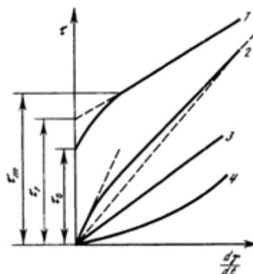
жидкости; в -псевдопластики; г-дилатантные жидкости;
