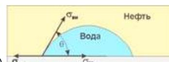
Задание № 15: Гидрофобной поверхности соответствует краевой угол смачивания  $\theta$  (рисунок)
