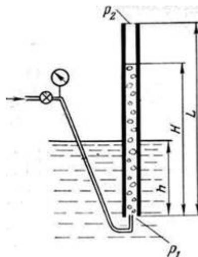
Задание № 18: Формула для расчета высоты столба жидкости в подъемной трубе (рисунок
