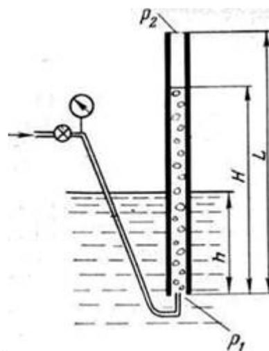
Задание № 20: Формула для расчета высоты столба жидкости в подъемной трубе (рисунок
